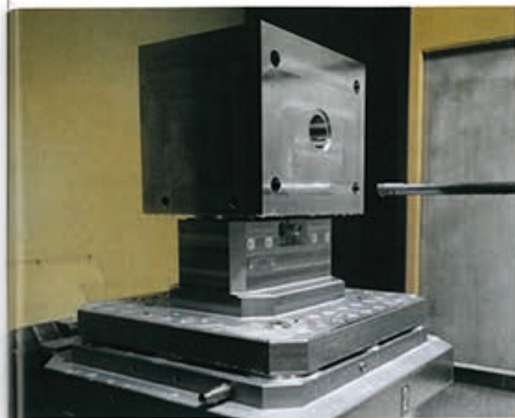
Die großen Haltekräfte und die Wiederholgenauigkeit der AMF Nullpunktspannmodule sind speziell für die Präzision der Tieflochbohrungen extrem wichtig (Bild: AMF)
